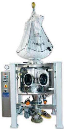
Big-Bag-Entleerung mit Endlos-Folien-system in Glove-Box
