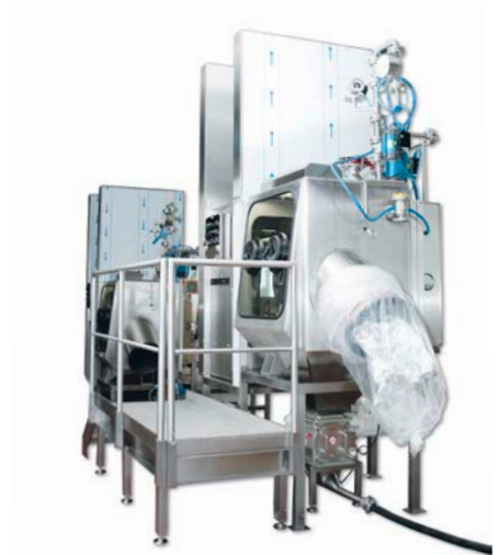
Sackaufschüttung mit Überdruck-schleuse, Glovebox, Bag-Out-System, Knollenbrecher und pneumatischer Förderung
