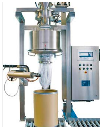
Endlos-Folien-Befüllanlage mit Vibro-Dos®, pneumatischer Clipper, Waage und Rollenbahn
