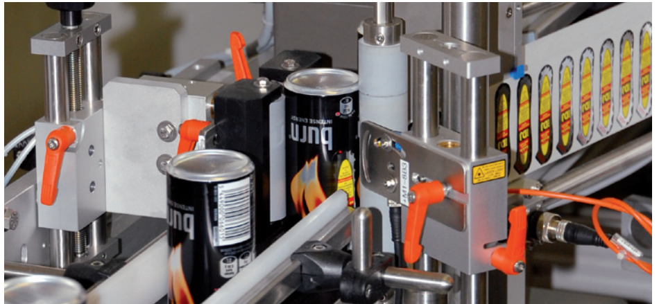
Mit einem Laser wird der Abtastpunkt definiert, um die Etikette positionsgenau zu spenden.
