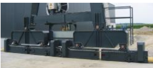
Spezial-Fahrwerk mit 8 Laufrädern und 4 Antrieben pro Seite
