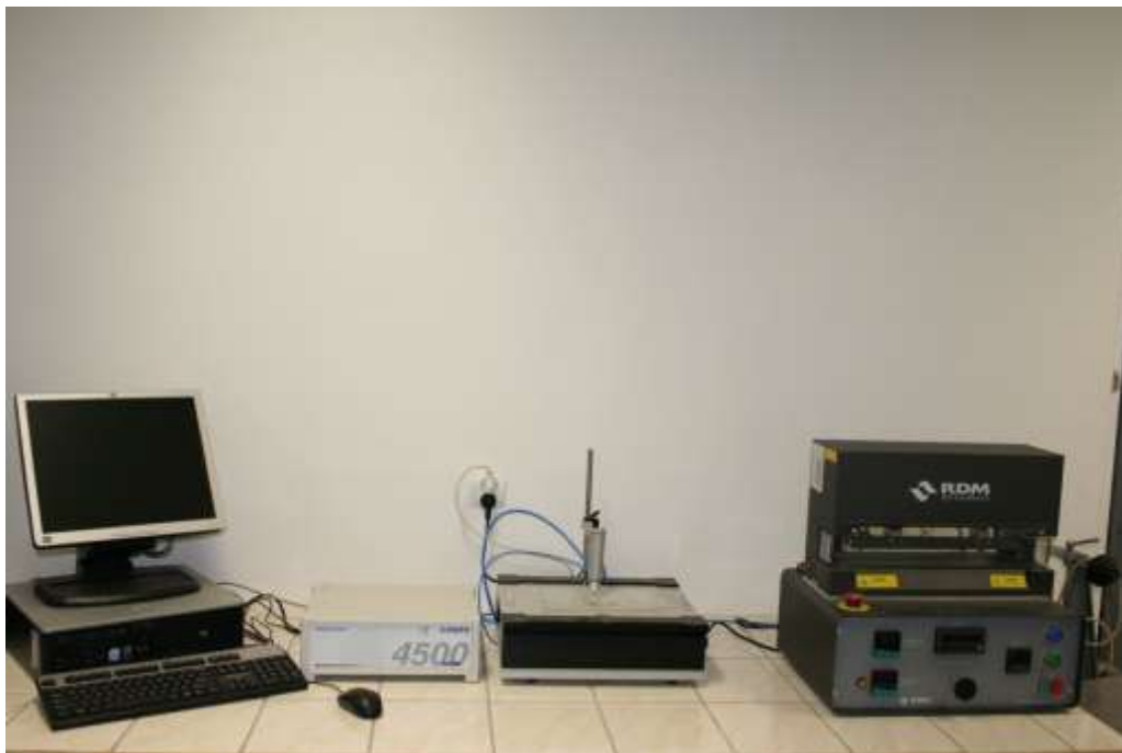
HSE-3 zgrzewarka laboratoryjna (RDM, UK) 4500SL – szczelność i wytrzymałość zgrzewu (Lippke, D)
